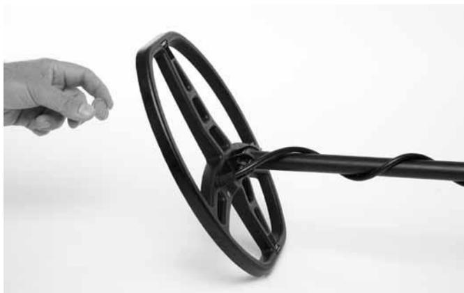
Для стендовой проверки поместите катушку на плоскую устойчивую немаetalлическую поверхность, находящуюся на расстоянии нескольких футов (1-1,5 м) от прочих metalлических предметов.
