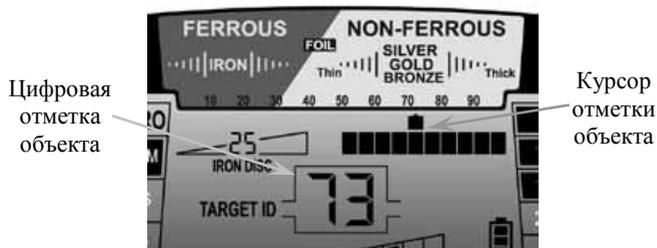
Цифровая отметка объекта в *AT Pro* даёт некоторое соответствующее объекту число, которое помогает более точно его идентифицировать. Объекты идентифицируются на ЖК дисплее числом, при этом чем он ближе к 1, тем больше в них железа. Отметка от объектов с максимальной проводимостью (например, массивные серебряные изделия) ближе к 99.
